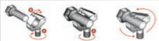
Girar o punho serrilhado A para abrir as lâminas.
